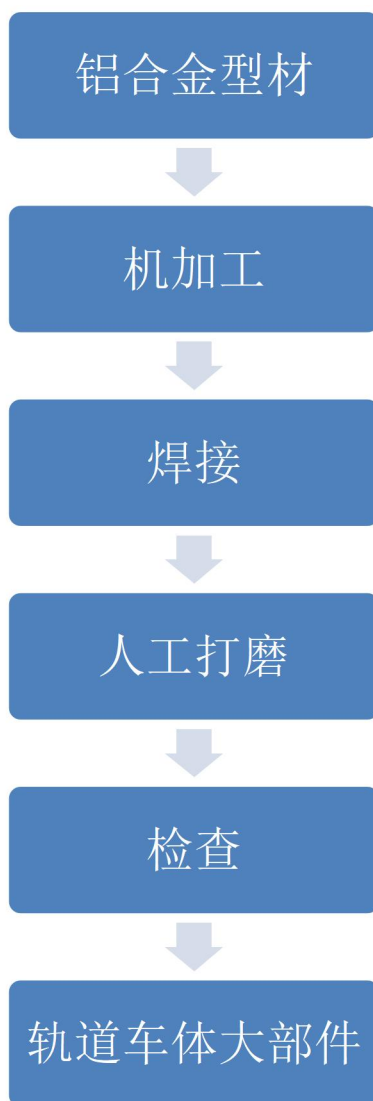
图 4.1 产品生产流程图
